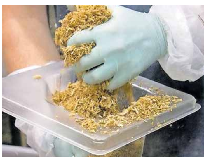
Architektonische Visionen: Der „Mycotree“ wurde 2017 bei der Seoul Biennale of Architecture and Urbanism gezeigt (großes Foto). Er besteht aus Pilzmyzelium und Bambus und hat eine selbsttragende Struktur. Solche Bausteine entstehen, indem Pilzsporen mit Holzspänen oder anderen pflanzlichen Abfällen gemischt werden (kleines Foto links). In wenigen Tagen wächst eine dichte Substanz aus Zellfäden heran; die Masse lässt sich in fast jede Form füllen (Foto rechts). Wissenschaftler hoffen, dass damit künftig sogar Häuser errichtet werden können. FOTOS: MYCOTREE, ECOVATIVEDESIGN.COM (2)
